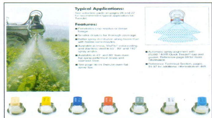
Obr. 1: Zobrazení činnosti „Twin Jet“ trysek, podle Scheperse, (2001)
