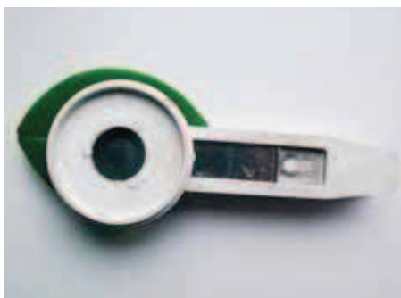
Obr. 2: Listový klip, používaný k měření rostlin adaptovaných na tmu. Ilustrační foto
