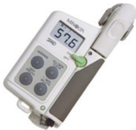
Obr. 2 Použitý prístroj pre nepriame meranie obsahu chlorofylu – SPAD-502 (Minolta, Japonsko) (URL 4)
