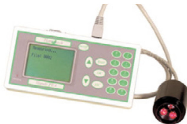
Obr. 3 Prístroj HandyPEA (Hansatech, Veľká Británia) pre stanovenie rýchlej kinetiky fluorescencie chlorofylu a (URL 5)
