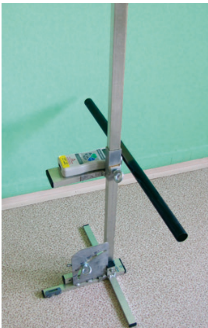
Obr. 2: Prototyp přístroje na měření síly nutné k vychýlení stébel (odporové síly)
