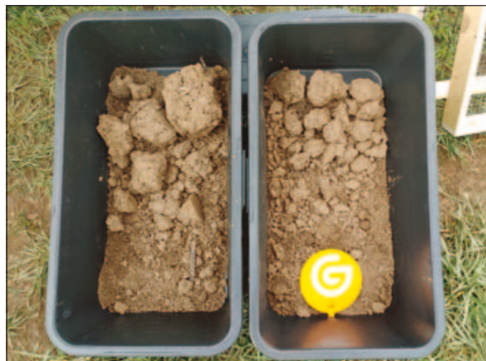
Obr. 2: Výsledek Drop testu v praxi. Vlevo kontrola, vpravo Nutrigeo L 25 l/ha podzimní aplikace
